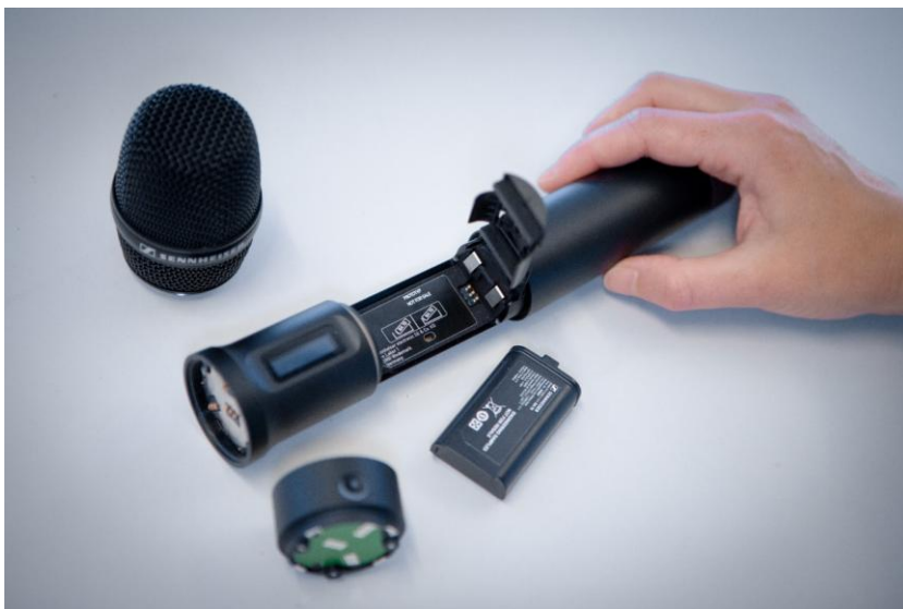
模块化设计：配备标准森海塞尔话筒头接口和 Command 适配器的森海塞尔 Spectera 手持麦克风
